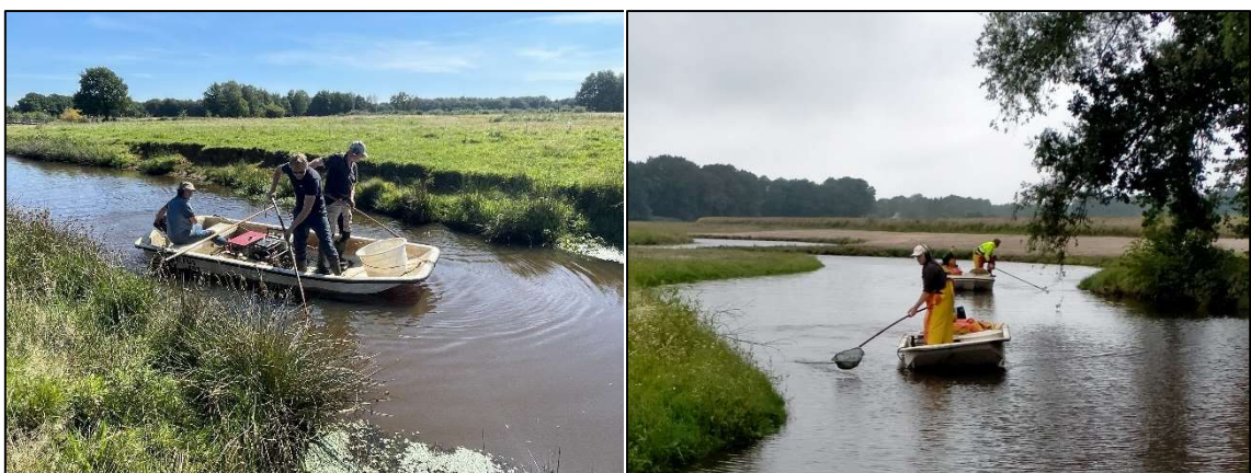
figuur 2.3 Electrovisserij op smalle trajecten vanuit één boot (links) en elektrovisserij op brede trajecten vanuit twee boten (rechts).
